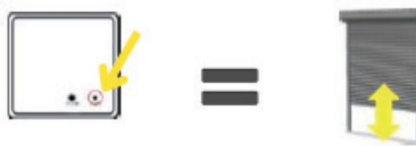
Appuyer sur la touche **PROG** de l'émetteur à effacer à l'aide d'un trombone durant **1 seconde**.
