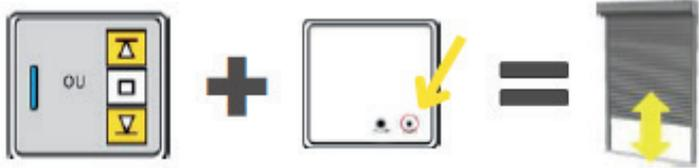
Positionner le volet sur la position à ajuster en appuyant sur la touche **montée ou descente**
